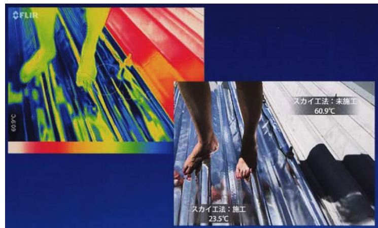
日中の屋根の温度変化の様子 (施工箇所の表面温度は23.5℃、未施工の箇所は60.9℃)
