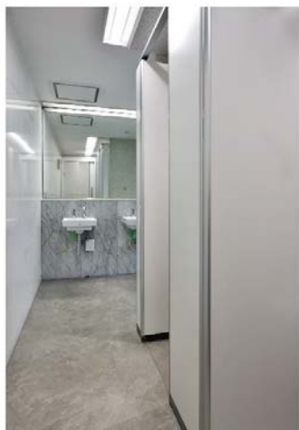
女子トイレ内観 和便器の洋式化(リモデル工法)、TB の改修、自動水洗付き手洗い流し取替、男子トイレとの間に遮音壁設置、床材を長尺シートに張替え、壁・天井塗装替え、LED 照明器具取替 (1～8 階共通)
